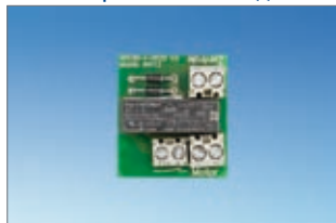
Рис. 8-7 Для ограничения хода в дополнение к плате ограничения хода необходимо смонтировать базовый модуль (см. чертеж 45130-9-0990).
