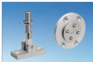
Рис. 8-5 С помощью поворотного кронштейна шпindelный привод E350 N в тандемном исполнении может быть прикреплен непосредственно к наплав створки. Благодаря этому достигается большая открывания открытия в отличие от крепления с аналогичным ходом на основной кромке закрывания слухового окна. (В комплект поставки входят рым-болты, створочная опора и винты с потайными головками.)
