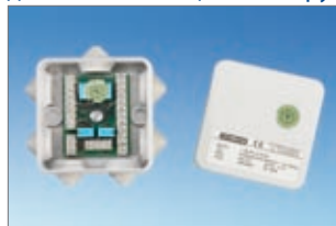
Рис. 8-8 Для сигнала положения в дополнение к плате сигнализации положения необходимо смонтировать один или два базовых модуля в зависимости от случая применения (см. чертеж 45130-9-0990).
